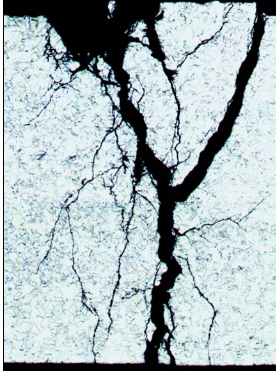
Şekil 9. Sıcak su boilerindeki gerilme yırtığı korozyonuna uğramış 100:1 oranında büyütülmüş bir paslanmaz çelik boru kesiti (malzeme 1.4541). Kullanma suyunun temas ettiği yüzeyden başlayan bir ana yırtık ve altta da delik korozyonu görülmektedir.
