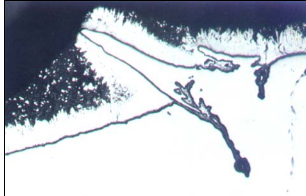
Şekil 3. Dikişli galvaniz borunun 200:1 büyütülmüş dikiş kesiti. Boru içi kısmındaki dikiş ucunda galvaniz kaplamanın olmadığı açıkça görülmektedir.
